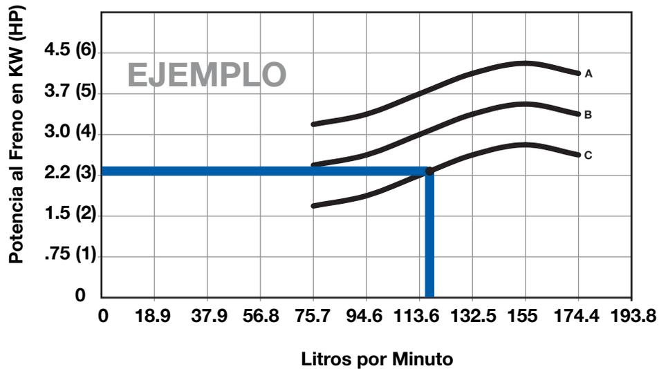
FIG. 2 CURVA DE LA BOMBA DEL FABRICANTE
