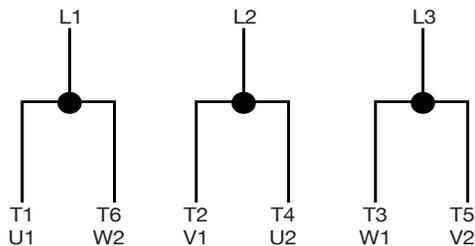
Los arrancadores ESTRELLA - TRIANGULO se conectan al motor durante el arranque como se muestra abajo, después cambia a la conexión de operación como se muestra a la izquierda.
